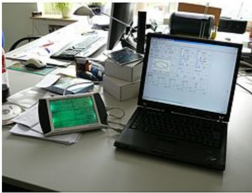
Qui può osservare la centrale meteorologica PCE-FWS 20 connessa ad un portatile tramite il software
